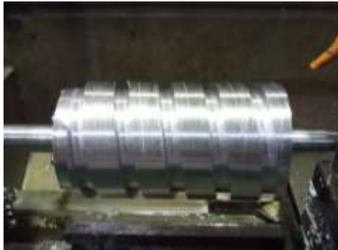
Gambar 4. Komponen giling model screw sebelum dirakit
